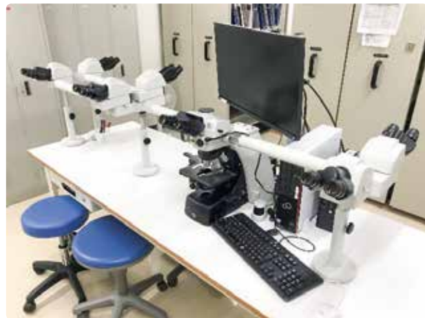
7名までの人数で1つの症例を供覧できる顕微鏡。難しい症例は専門家を交えてディスカッションを行い、診断を下しています。
