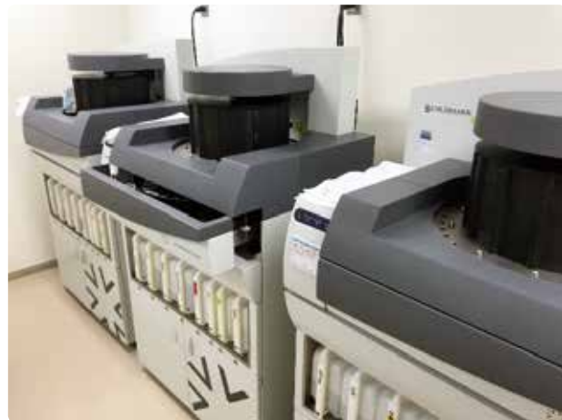
Ventana社製自動染色機。1回の操作で多数の免疫染色を自動でおこなうことができます。
